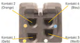
Abb. XI-17: Rückwärtige Ansicht Datenmodul
