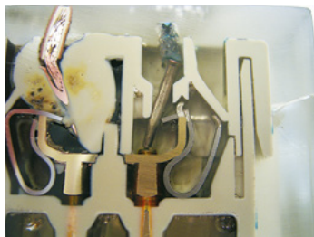
Abb. VI-7: Folgen einer fehlerhaften Montage am Beispiel Han® ES – Zoom
