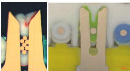
Abb. XI-2 und XI-3: Schlechte Schneidklemmverbindungen
