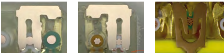
Abb. XI-1: Optimale Schneidklemmverbindung für starre und flexible Leiter
