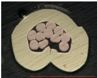
Abb. V-7: Schliffbild einer fehlerhaften Probe, Leiterquerschnitt zu gering
