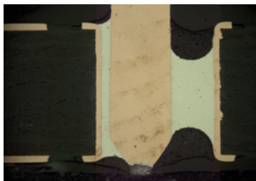
Abb. IX-10: Lötverbindung mit grenzwertigem Füllgrad
